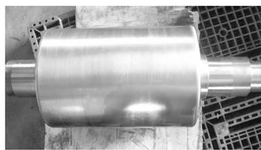
图4  $\Phi 25-100$ 二辊不锈钢棒材矫直机凸辊
