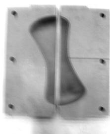
图5 二辊棒材矫直机导向板正面
