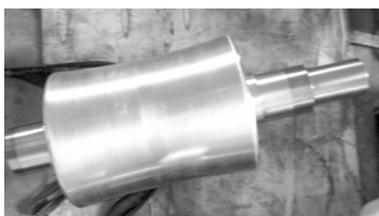
图3  $\Phi 25-100$ 二辊不锈钢棒材矫直机凹辊
