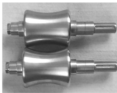
图2  $\Phi 3-12$ 十辊钽合金管材矫直机中间辊
